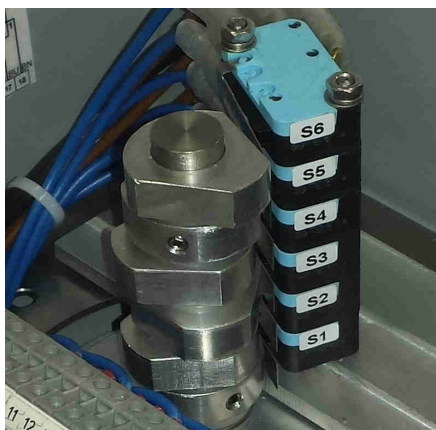
4 - 250 V AC/DC Endschalterbox 6 Schalter und 4 Schalter , 6 mechanische. Crouzet-Endschalter und 4x mechanische Crouzet-Endschalter, IP 65, - 20°C bis + 80°C
