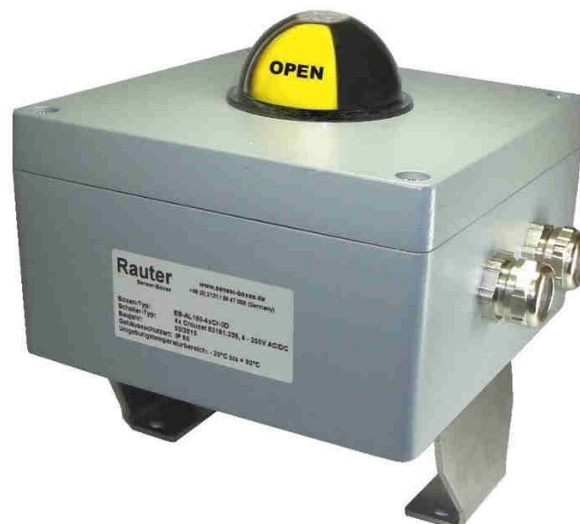
4 - 250 V AC/DC Endschalterbox mit 3D-Anzeige, Aluminium-Geh., 160x160x90mm, 4x mechn. Crouzet-Endschalter SPDT, IP 65, - 20°C bis + 70°C
