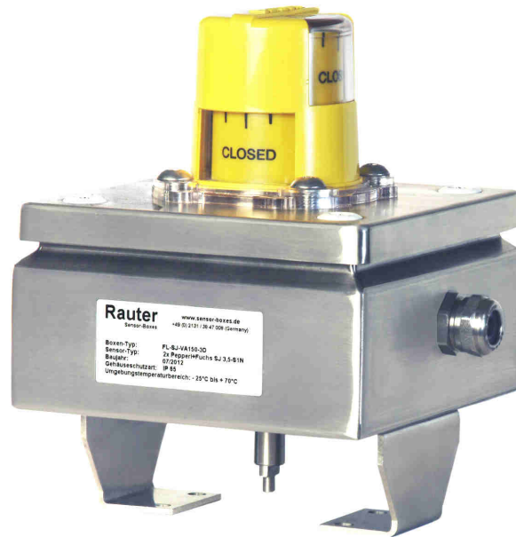
Ex i ... 8 V DC Endschalterbox mit 3D-Anzeige, Edelstahl-Gehäuse, 150x150x80mm, 2x P+F SJ 3,5-S1N, IP 65, - 25°C bis + 70°C
