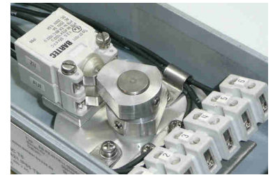
Bartec-Endschalter: mechn. druckfest gekapselt
