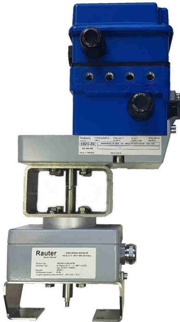
Ex ed ... 4 - 250 V AC/DC Aluminium-Endschalterbox, Abm.: 125x80x57, F05/F05-Edelstahl-Konsole mit Eckardt-Foxboro-Stellungsregler und Edelstahl-Konsole für Antriebe mit Schnittstelle nach VDI/VDE 3845, Umgebungstemperaturbereich der kpl. Endschalterbox: - 40°C bis + 70°C
