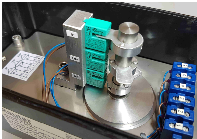
Bild 11+12: 3x SJ 3,5-S1N für 2x Stellung AUF und 1x Stellung ZU , 0° und 90°, 3x SJ 3,5-N für 0°, 120° und 240°
