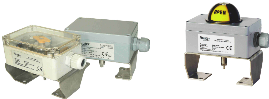
Bild 1+2: links: Crouzet-Endschalterbox mit 2D-Sichtanzeige im Polyamid-Gehäuse, Abm.: 120x80x55mm sowie Crouzet-Endschalterbox im Aluminium-Gehäuse mit geschlossenem Deckel, Abm.: 125x80x57mm, rechts: Crouzet-Endschalterbox mit 3D-Sichtanzeige im Aluminium-Gehäuse, Abm.: 125x80x57mm, beides mit montierten Edelstahl-Konsolen für Drehantriebe mit Schnittstelle nach VDI/VDE 3845.
